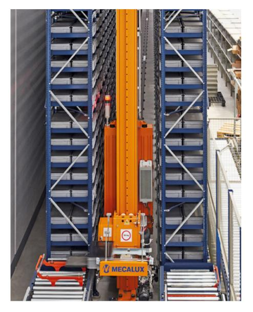
El almacén automático incorpora un transelevador monocolumna que opera en un pasillo de sólo 87 cm de ancho y cubre una longitud de hasta 43 m
