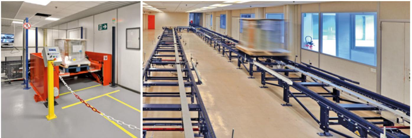
En el inicio del circuito, los operarios ayudados por carretillas introducen los palets en una mesa hidráulica, que eleva la carga hasta la altura del transportador. Una vez el palet ha llegado a su destino, otra mesa hidráulica lo descende hasta el nivel del suelo para que los operarios lo retiren del circuito.
