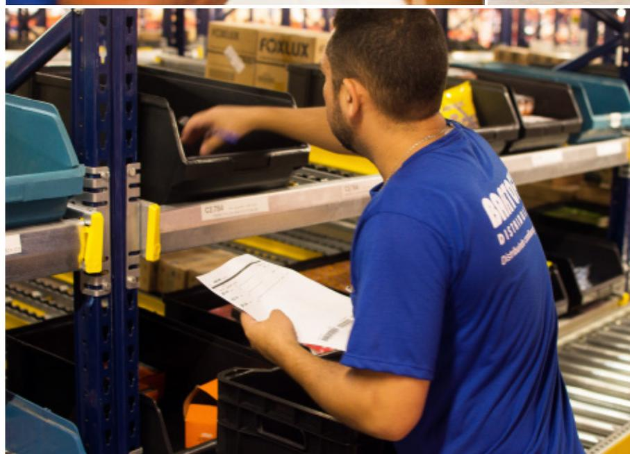
Entre los dos bloques de estanterías dinámicas se encuentran estanterías de picking dinámico. Están compuestas por tres plataformas con roldanas y poseen una ligera inclinación para que las cajas se desplacen por gravedad. La ventaja de estas soluciones para el picking es que siempre hay stock disponible para que se pueda efectuar la operativa.
