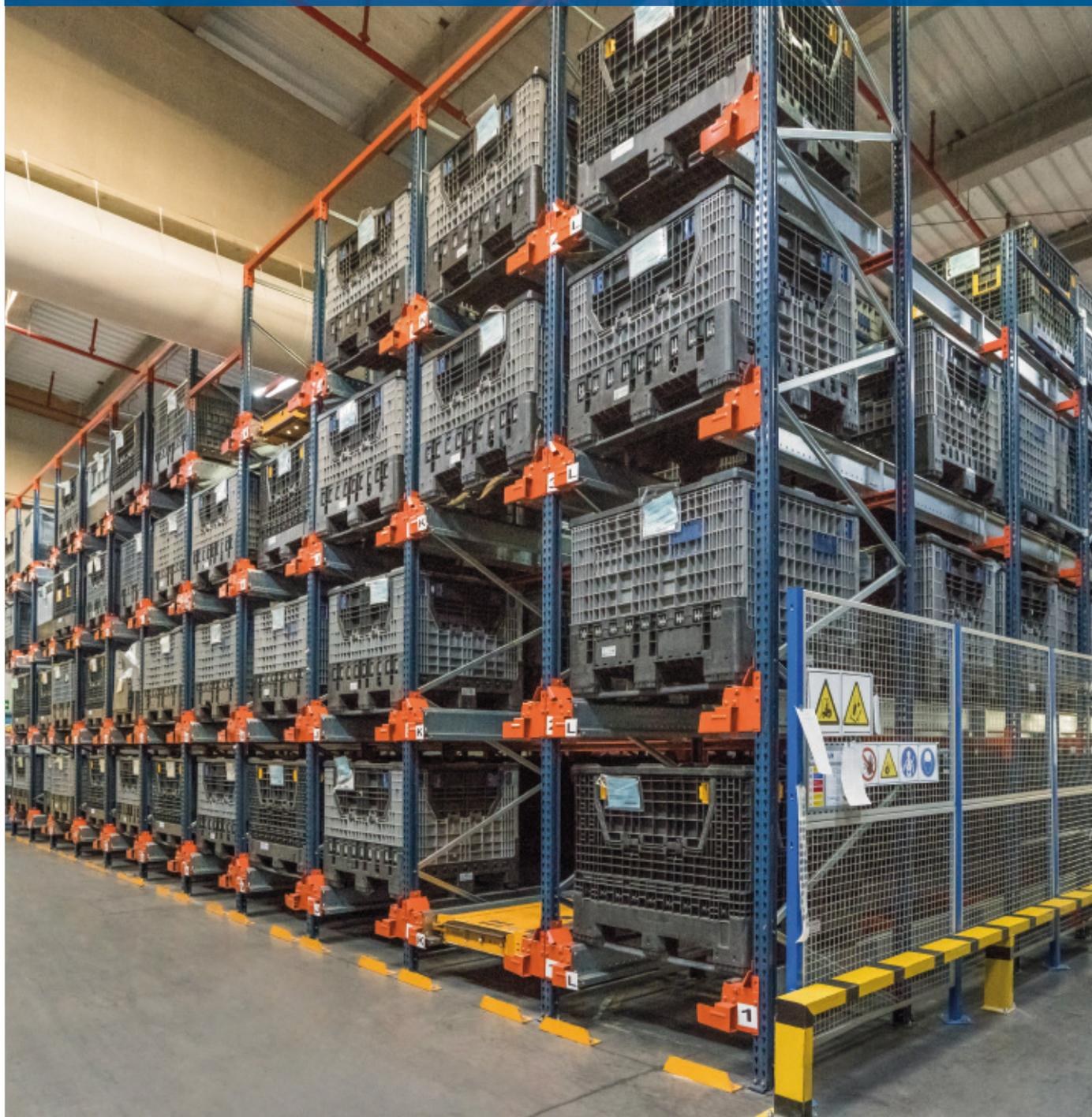
Saargummi, empresa fabricante de perfiles de estanqueidad (principalmente de caucho), ha renovado sus instalaciones logísticas en Madrid con un nuevo bloque de estanterías con el sistema Pallet Shuttle semiautomático y estanterías convencionales. Las dos soluciones de Mecalux, que ofrecen una capacidad de almacenaje total para 853 palets, tienen en común la agilidad que proporcionan a las entradas y salidas de la mercancía.
