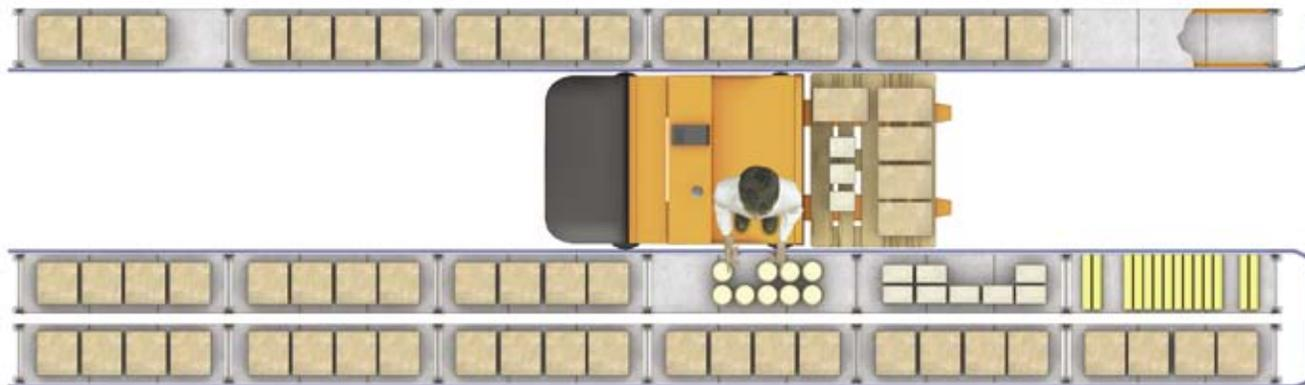
Cada modelo de máquina necesita un tipo de carril guía y un ancho de pasillo diferente. El ancho del pasillo viene definido por la distancia entre los carriles guía y la distancia entre los niveles de carga.
