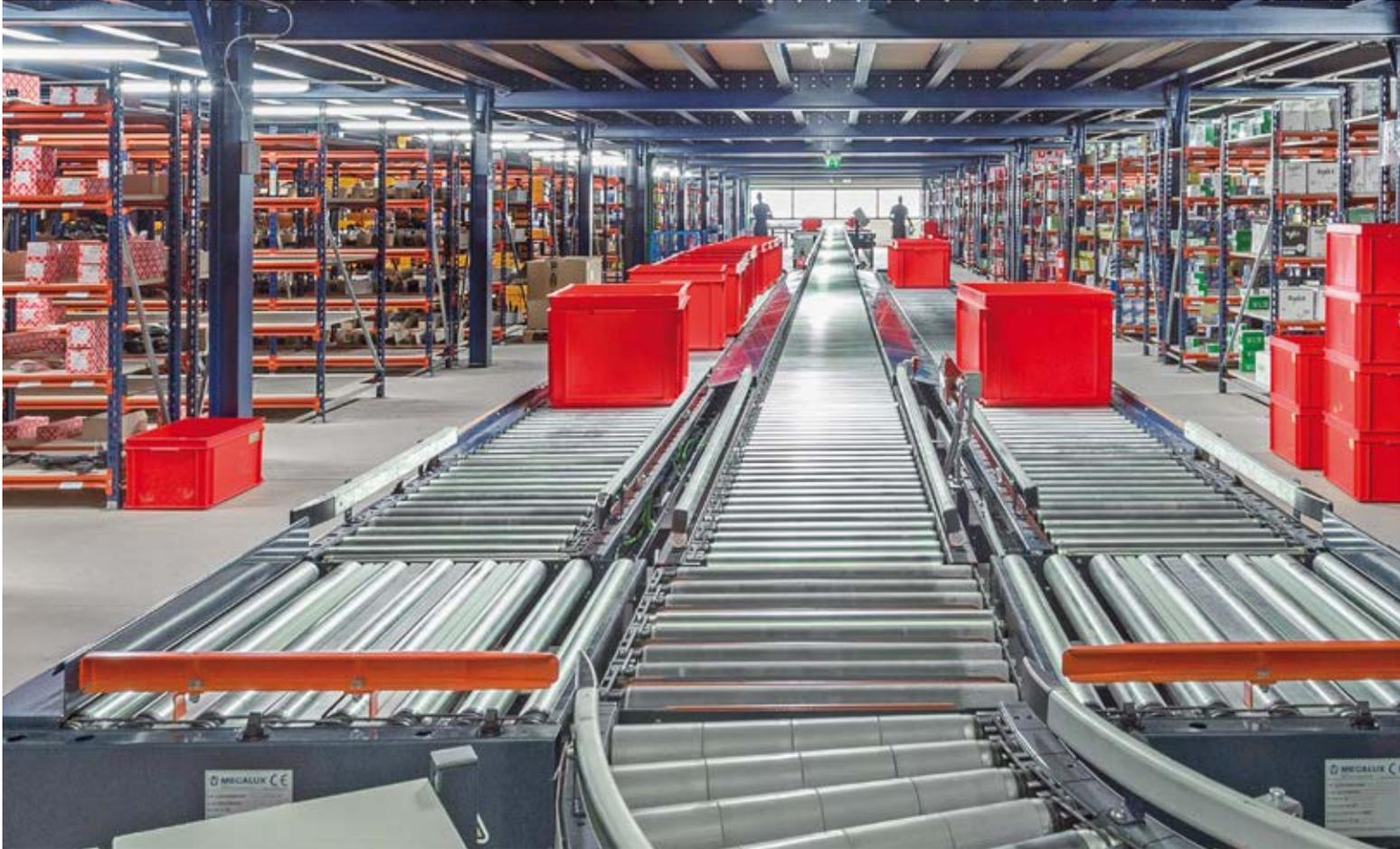
Los transportadores de cajas son elementos de manutención creados para trasladar o manipular cargas ligeras de forma controlada y continua mediante un sistema mecánico de arrastre de rodillos, correas o bandas. Optimizan los movimientos dentro del almacén, mejorando la eficiencia y competitividad de la empresa.
