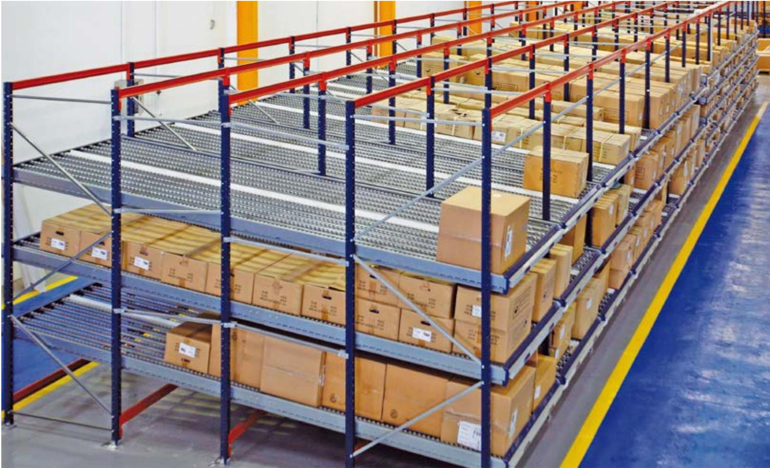
En los racks 'Carton Flow', la mercancía se almacena sobre plataformas de roldanas o rodillos, diseñados en plano inclinado de modo que la mercancía se introduce por un lado y se desliza, por gravedad, hasta el lado contrario que da al pasillo de salida.
