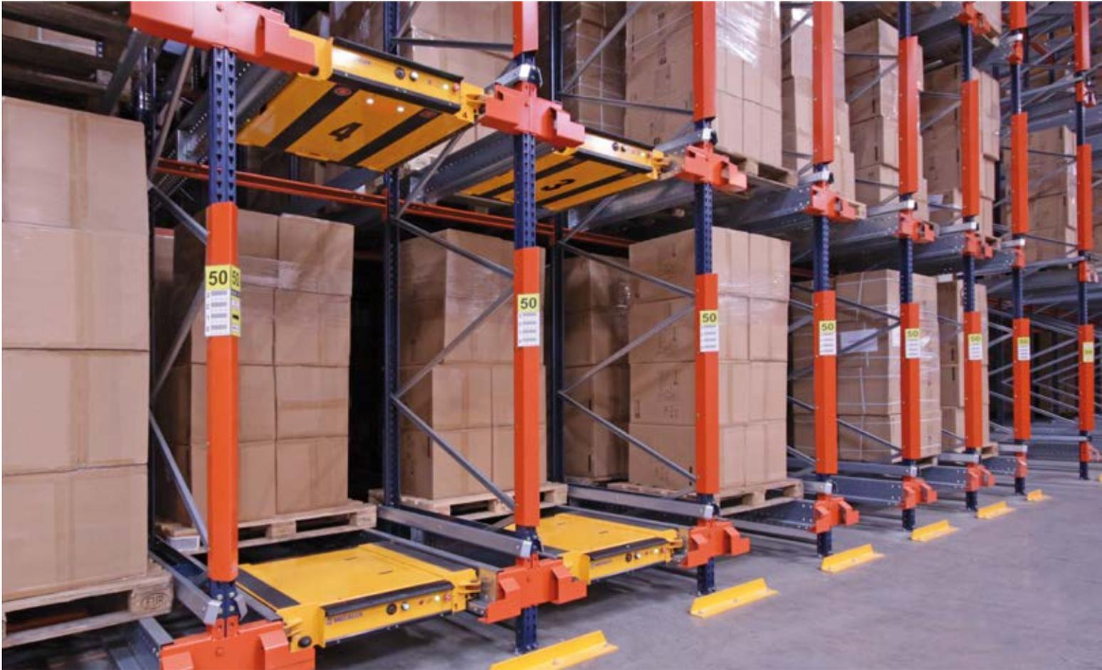
Sistema de almacenaje por compactación que utiliza carros para llevar a cabo, de forma autónoma, los movimientos en el interior de los racks, sin necesidad de que los montacargas elevadores entren dentro de las calles de almacenaje.
