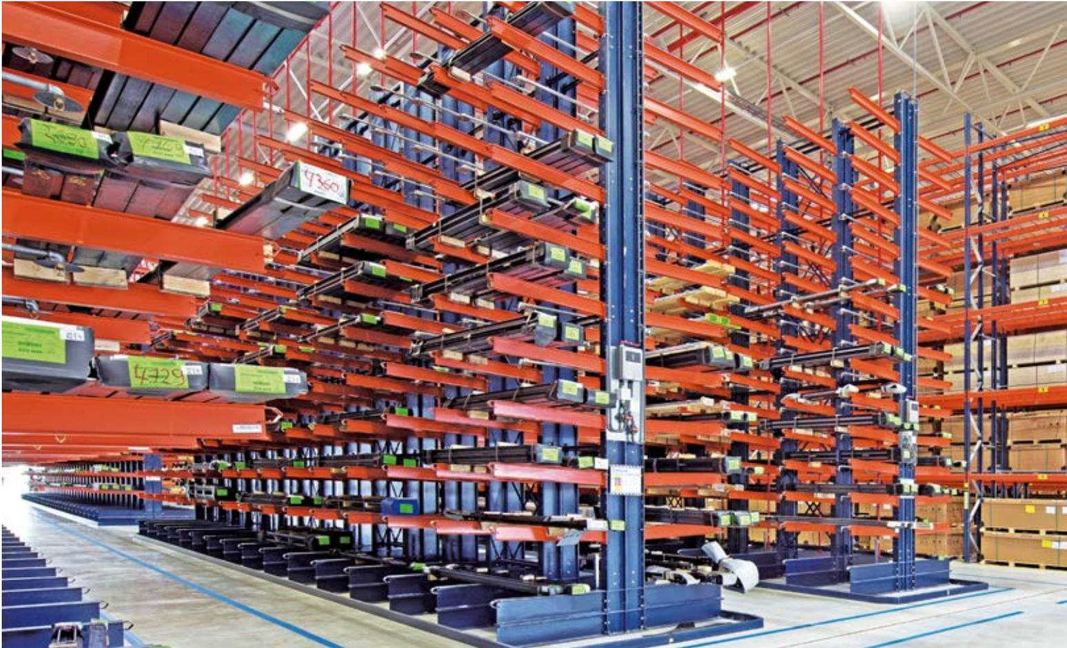
Están compuestos básicamente por columnas, formados por un perfil vertical y uno o dos perfiles horizontales colocados en su base para darle estabilidad. A las columnas se fijan una serie de brazos en voladizo sobre los que se deposita la carga.
