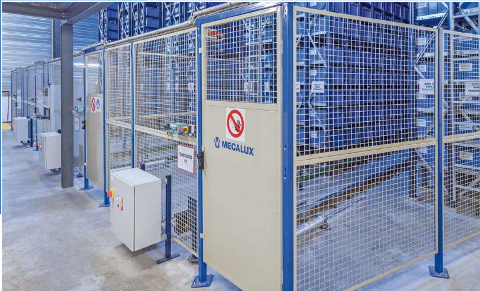
Los cierres de seguridad crean un espacio protegido en el área de trabajo de instalaciones automáticas y robots de fabricación. Asimismo, preservan la zona del riesgo de posibles materiales desprendidos por la acción de las máquinas.
