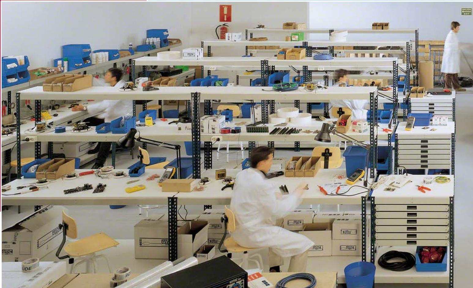
Estanterías sin tornillos para el almacenamiento manual de cargas ligeras y medias de alta resistencia para obtener las máximas prestaciones con el mínimo dimensionado de los perfiles, optimizando así el uso de toda la superficie de carga.
