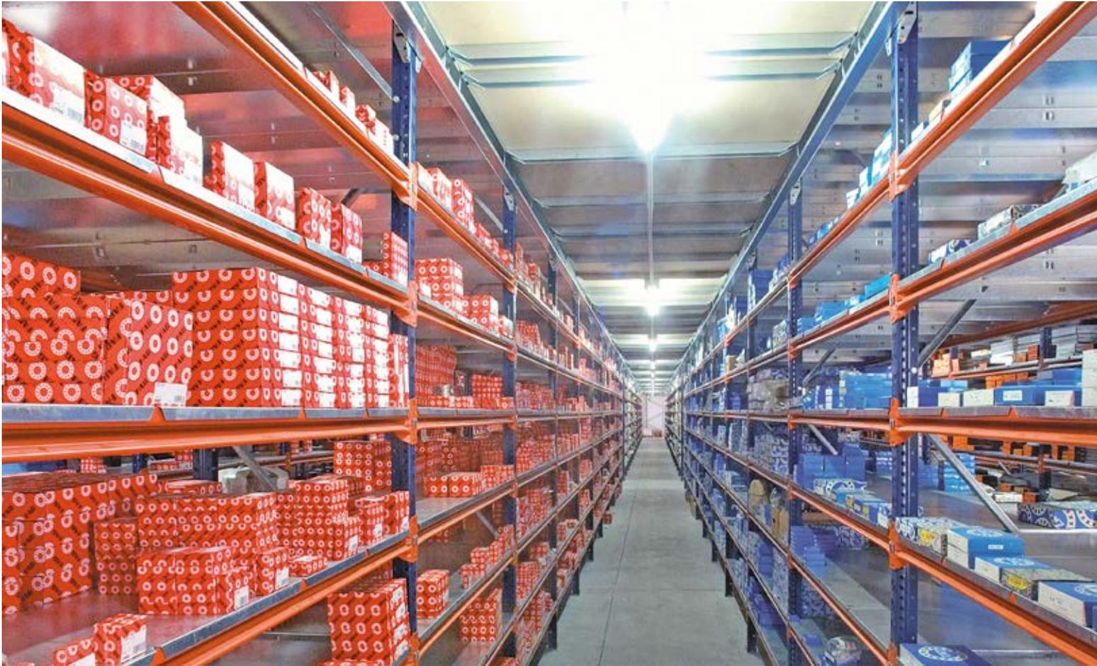
Diseñados para aquellos almacenes donde la mercancía se deposita y retira manualmente. Este sistema aprovecha toda la altura del almacén, ya que se puede acceder a los niveles altos tanto por medios mecánicos, que elevan al operario hasta la altura deseada (transelevadores o montacargas *stock-picker*), como mediante pasarelas colocadas entre los racks.
