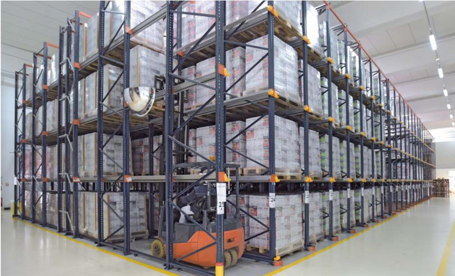
Sistema de almacenaje por acumulación compuesto por un conjunto de racks, que forman calles interiores de carga, con carriles de apoyo para las tarimas. Los montacargas penetran en dichas calles interiores con la carga elevada por encima del nivel en el que va a ser depositada.
