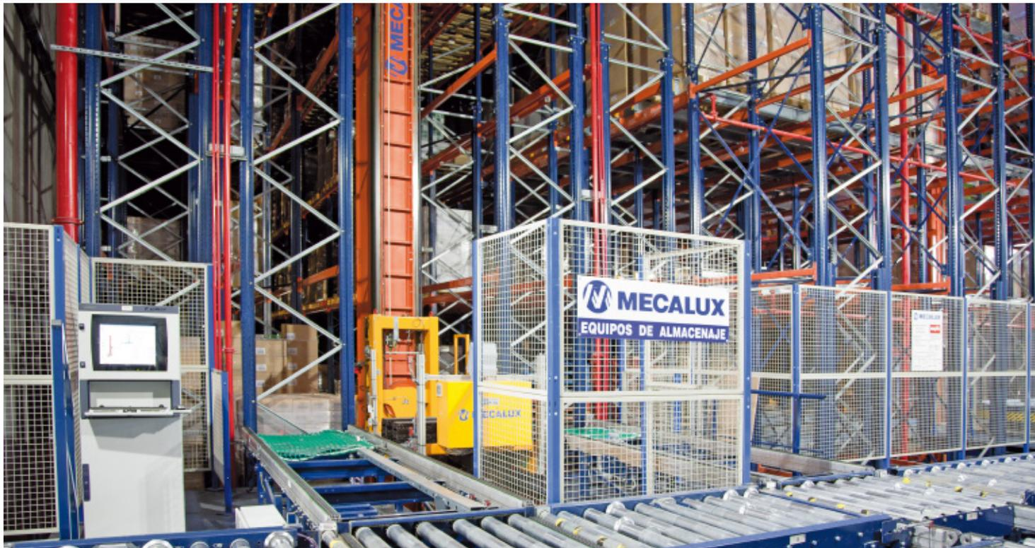
✓ La diferencia fundamental entre ellas radica en el potencial de tarimas que es capaz de mover una solución con lanzaderas frente a una con transelevadores. En los ejemplos mostrados en estas páginas, el potencial de la lanzadera se multiplica por cinco. Esto significa que la combinación de Pallet Shuttle y lanzadera por cada nivel permite **aumentar considerablemente el número de ciclos**.
