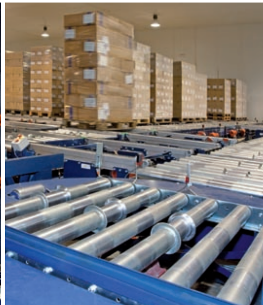
Transportadores de zona de precarga.
