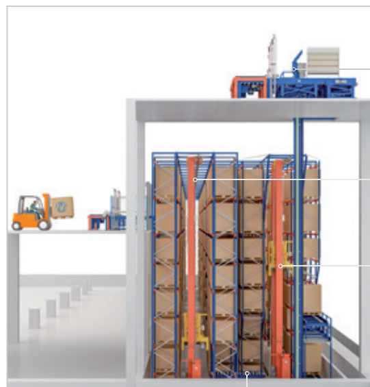
Transportadores Conectan ambos pasillos de almacenaje para transferirse palets
