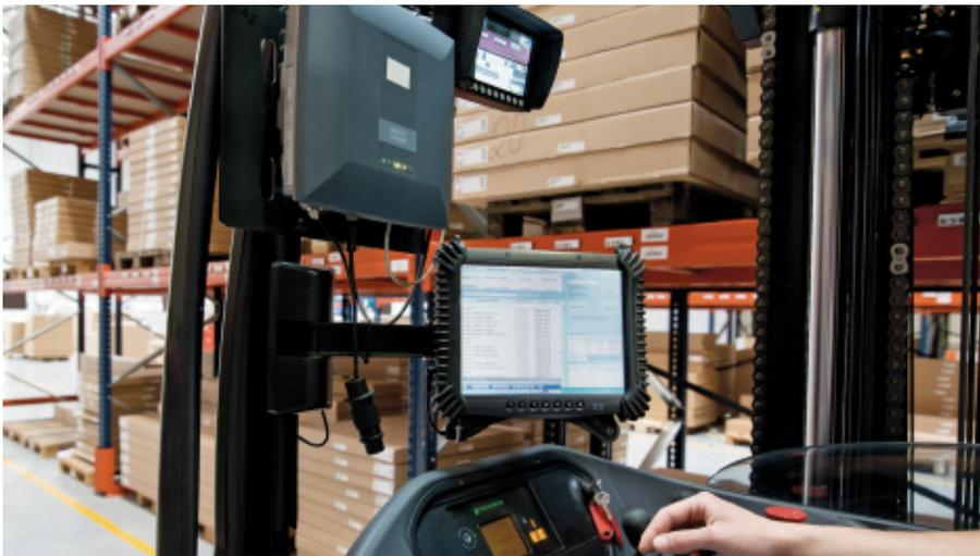
Para facilitar la manipulación de los palets y evitar posibles impactos contra las estanterías, las horquillas de las carretillas incorporan una cámara en su parte superior y sus imágenes se visualizan en una pantalla de la cabina del operario
