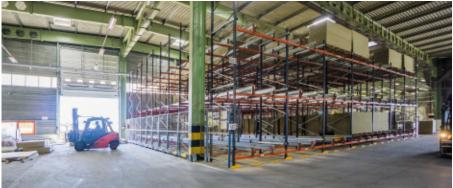
La gran anchura de los canales facilita el almacenamiento de palets de 1.000 x 2.400 mm con un peso de 200 kg
