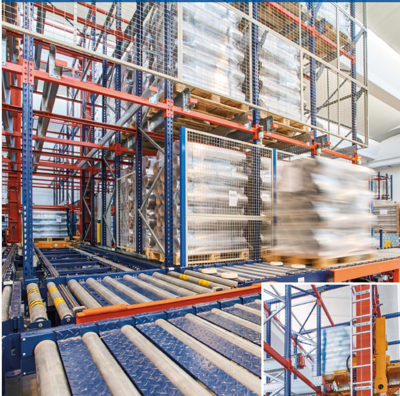
Con la inauguración de un nuevo almacén automático en Miradolo Terme (Italia), VI-MA, fabricante de componentes para envases de metal, ha optimizado su logística con el fin de reforzar la expansión del negocio. Mecalux lo ha equipado con el sistema Pallet Shuttle atendido por un transelevador y el software de gestión de almacenes (SGA) Easy WMS. Capacidad, agilidad y flexibilidad caracterizan esta instalación.
