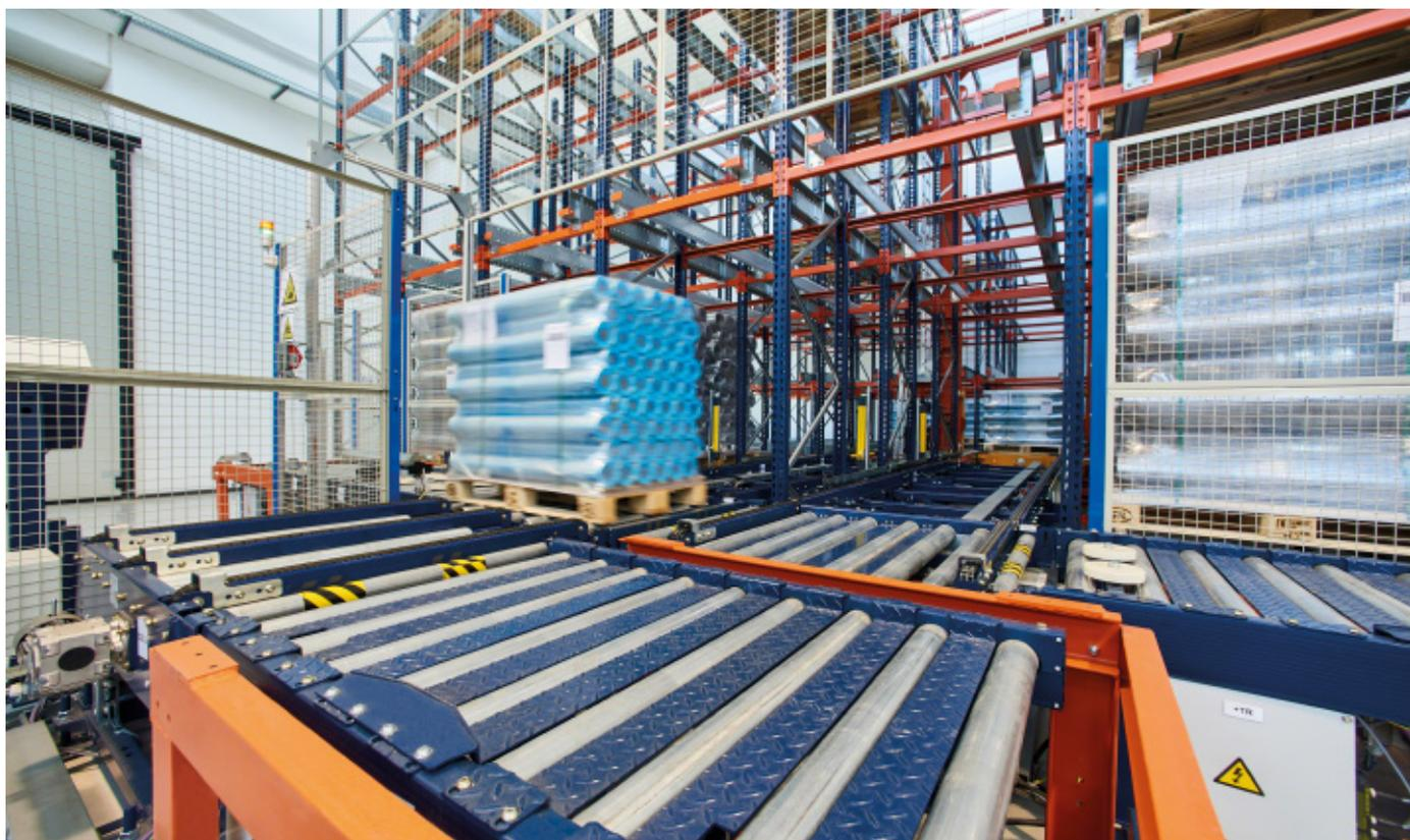
El nuevo almacén se halla justo al lado del centro de producción. Los operarios, con la ayuda de carretillas contrapesadas, recogen los palets de las líneas de producción y los trasladan directamente hasta el almacén.
