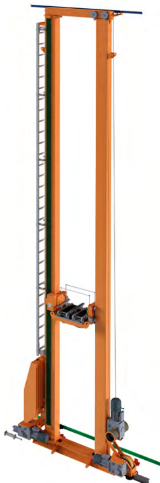
Transelevador bicolumna MLB100Q Capaz de alcanzar los 20 m de altura y transportar dos unidades de carga (de 100 kg cada una) o cuatro de 50 kg.
