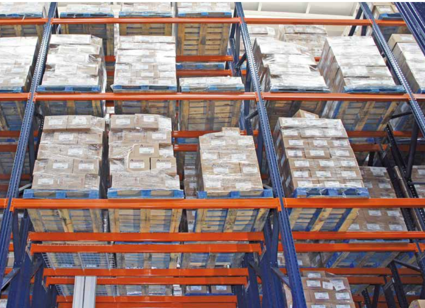
Almacén de rack selectivo. Tarima manipulada por el lado de 1016 mm
