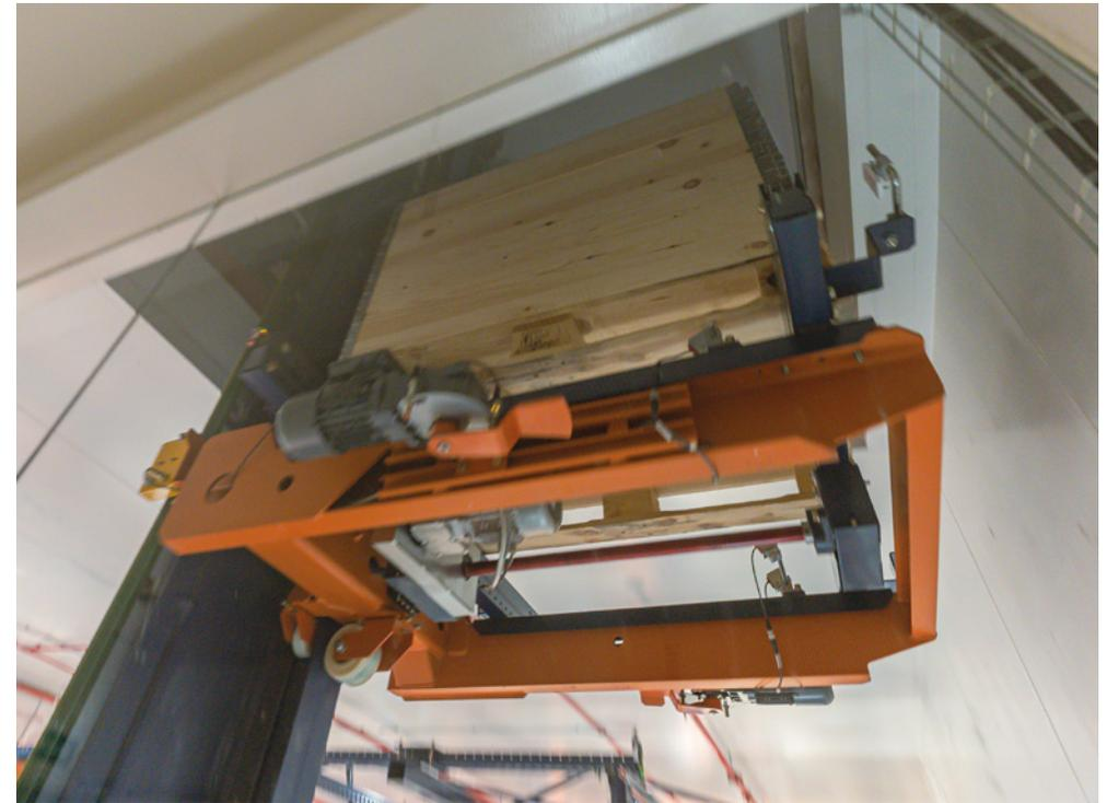
**El elevador comunica de forma bidireccional el almacén automático con las líneas de producción**
