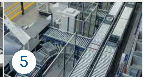
Por su parte, al completar un pedido, la **caja del nivel inferior se dirige a la zona de consolidación** y se coloca otra vacía para conformar un nuevo pedido.
