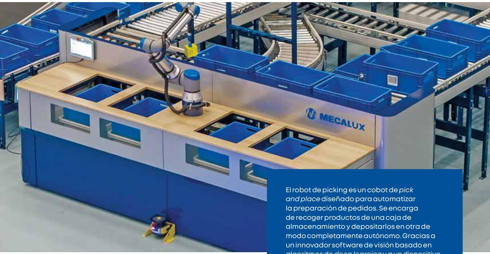
El robot de picking es un cobot de *pick and place* diseñado para automatizar la preparación de pedidos. Se encarga de recoger productos de una caja de almacenamiento y depositarlos en otra de modo completamente autónomo. Gracias a un innovador software de visión basado en algoritmos de *deep learning* y a un dispositivo de agarre de gran polivalencia, el robot manipula con absoluta precisión una amplia variedad de artículos de diferentes formas, superficies y dimensiones.
