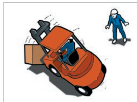
Figura 8 Pérdida del control del montacargas.
