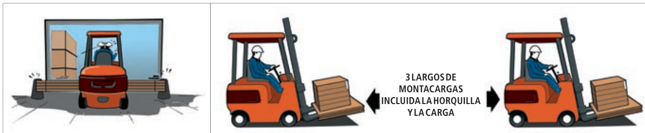
Figura 5 Atención a los límites de la instalación.
